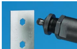
Werkstück mit dem erzeugten Sechskantloch, bereit zur Aufnahme der Hexsert® Blindnietmutter
