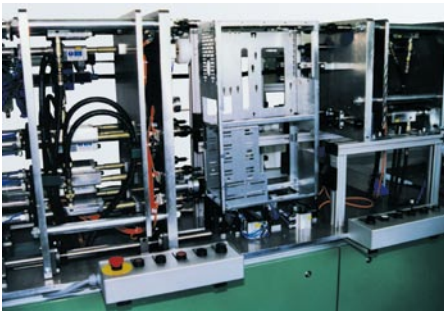
29 Nietmodule zur Komplettmontage von Computerchassis
