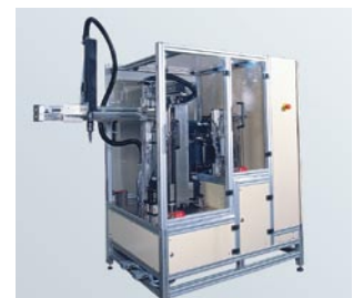
PMP System - Magazinriettechnik erlaubt Taktzeiten von ca. 1 Sek. Nietkopf sitzt auf NC-Achse
