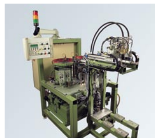
MIRS System mit zwei Nietköpfen zur Montage einer Vakuumpumpe
