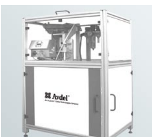
Nietspender zum einfachen Nachladen von Handgeräten - bis zu 6 Ladestationen sind anschließbar. Der Niet muss nicht von Hand vorgesteckt werden.
