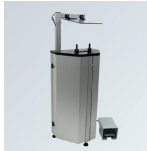
Mini-MBS bietet 2-fach Parallel-nietung und lineares Verschieben eines Nietmoduls für Nietabstände von 29 - 120 mm
