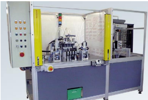
Mehrfachnietung mit automatischer Nietzufuhr und Prozessüberwachung
