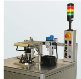
4-fach MBS zur Montage von zwei Typen Sicherheitsgurtaufrollern; Module sind gegen Anschlag auf zwei Positionen verstellbar
